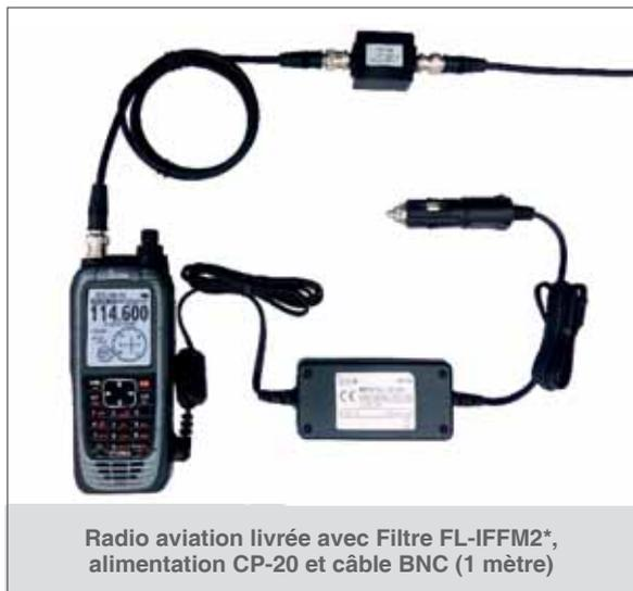
\*Un filtre réjecteur FM (FL-IFFM2) permet d'assurer l'immunité aux perturbations radio-électriques liées aux émetteurs radio diffusion.
